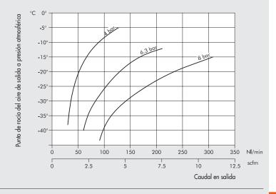
En los gráficos siguientes se indica el punto de rocío del aire comprimido en salida, por diferentes puntos de rocío del aire en entrada, en función del caudal.
